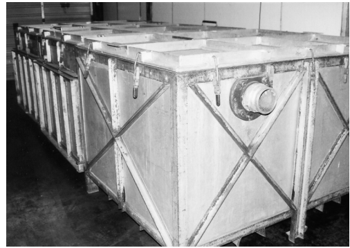
Figura 2. Caja metálica para la pasteurización del sustrato con vapor en Pennsylvania, EUA.
