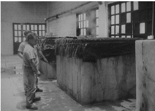
Figura 3. Sistema de pasteurización por vapor en la planta de San José (Zinacantán, Chis., México). El vapor es producido con un generador de leña.
