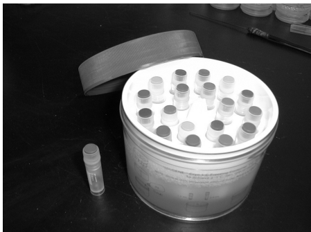
Figura 5. Contenedor criogénico para enfriamiento controlado y viales criogénicos para almacenamiento en nitrógeno líquido.
