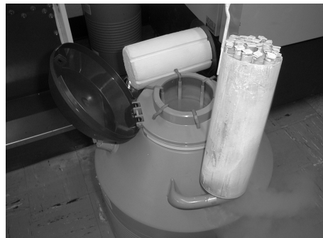
Figura 6. Almacenamiento en nitrógeno líquido. implementos requeridos: termo, canastilla, cañas y viales.
